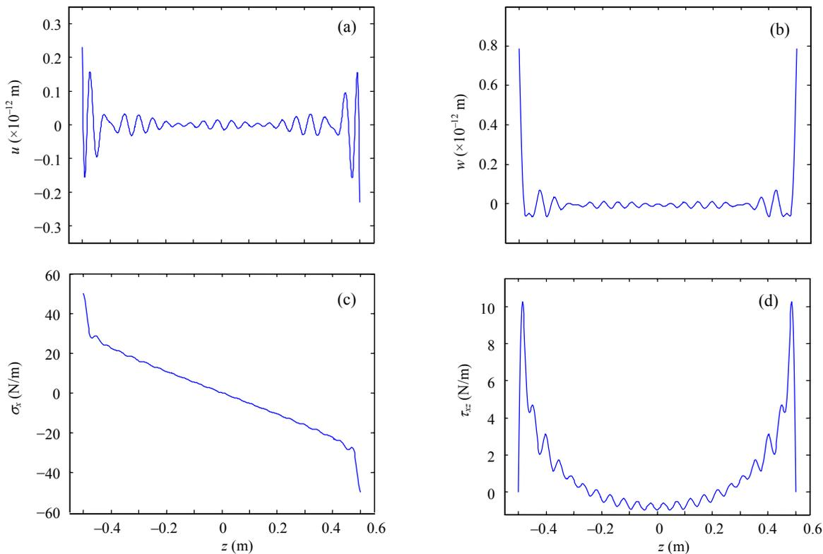
Fig.2 Stresses and displacements at the clamped end using Eq.(17). (a)  $u$ ; (b)  $w$ ; (c)  $\sigma_x$ ; (d)  $\tau_{xz}$
