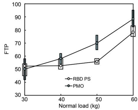
Fig. 5 Flash temperature parameter (FTP) distribution
